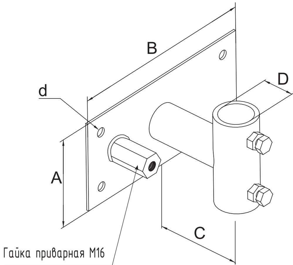
Предназначен для крепления мачты молниеприемника высотой 5-7 м на вертикальных конструкциях здания.
